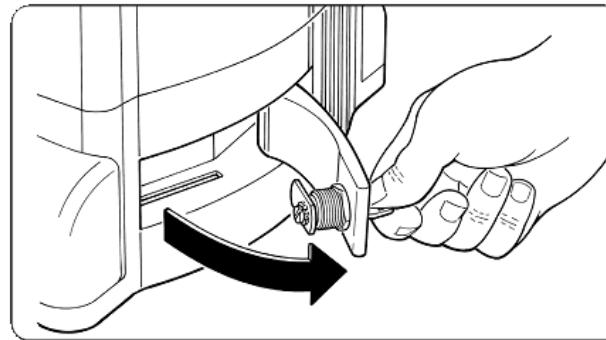
05. Чтобы восстановить нормальную работу системы автоматизации, переведите ручку в закрытое положение, поверните ключ в замочную скважину против часовой стрелки и вручную передвиньте створку ворот, пока не раздастся звук, подтверждающий, что створка ворот теперь управляема приводом.
